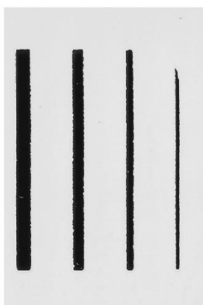
Uzorak 8 (debljina nanosa 21 \mu\text{m} i brzina otiskivanja 0,240 m/s)
