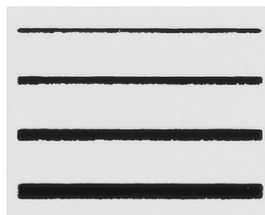
Uzorak 9 (debljina nanosa 21 μm i brzina otiskivanja 0,159 m/s)
