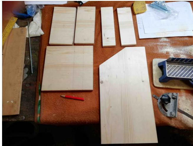
Slika 29. Svi dijelovi daske na okupu nakon brušenja
