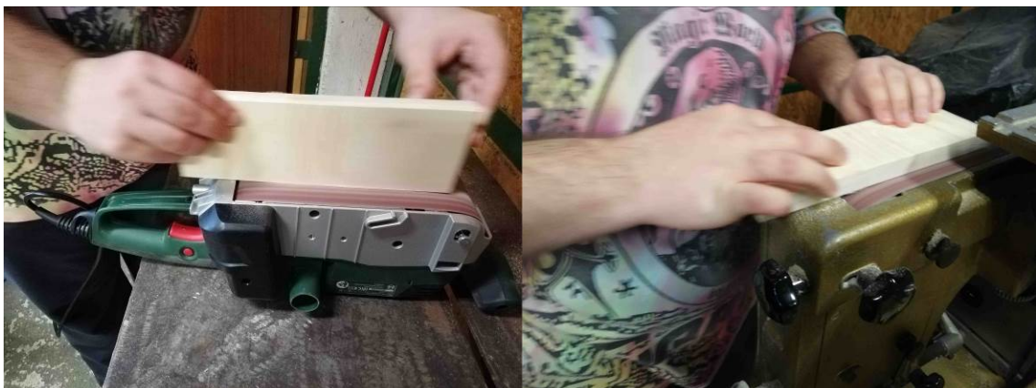
Slika 28. Brušenje izrezanih dijelova daske
