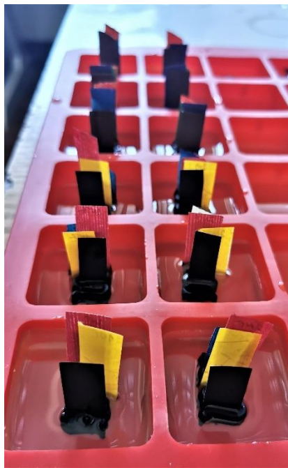
Slika 21. Otisnuti uzorci u epoksi smoli.
