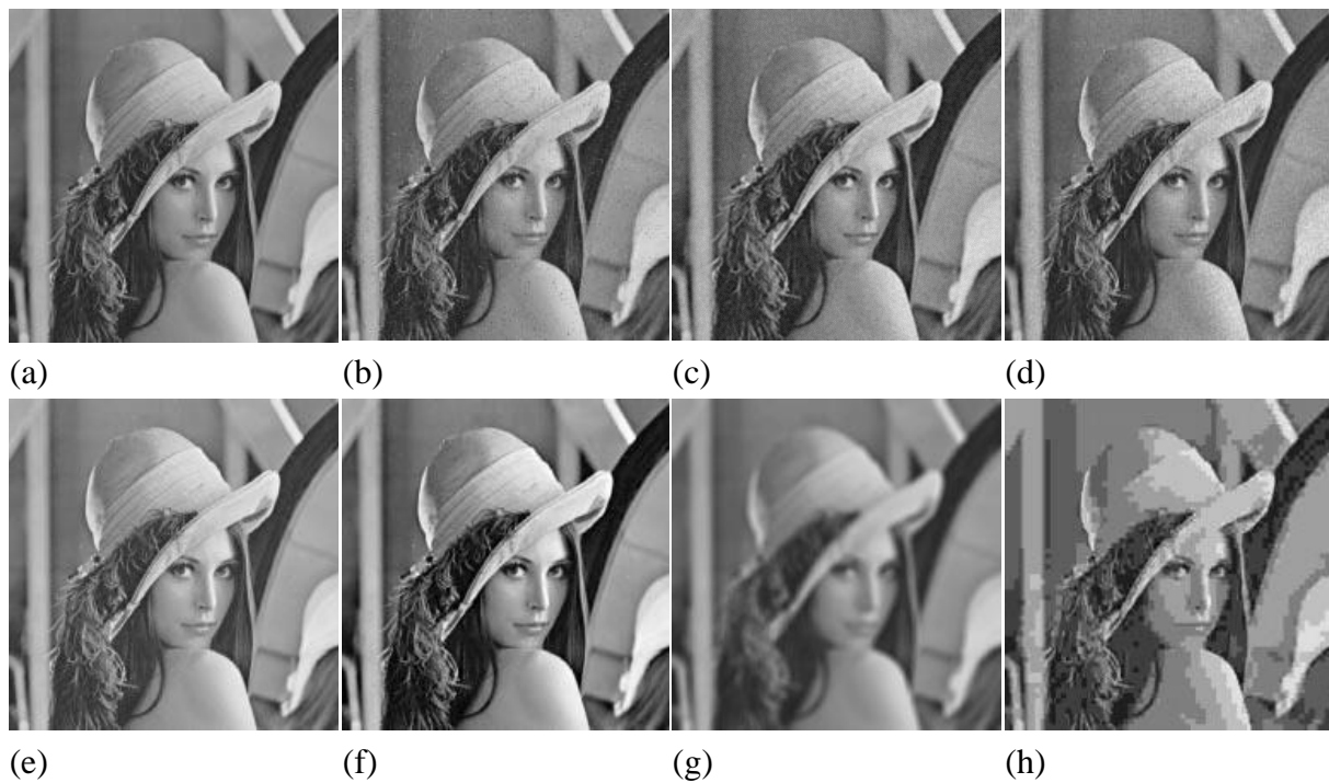
Slika 9. Evaluacija slike „Lena“ obrađene dodatnim filterima: (a) izvorna slika, (b) sol-papar, (c) aditivni Gaussian i (d) multiplikativni pjegavi šum ( multiplicative speckle noises ) (e) pomak srednjih vrijednosti, (f) rastezanje kontrasta, (g) zamagljivanje i (h) jpeg sažeta slika [60].
