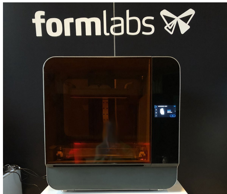
Slika 21 Uređaj za stereolitografsku aditivnu proizvodnju - Formlabs Form 3
