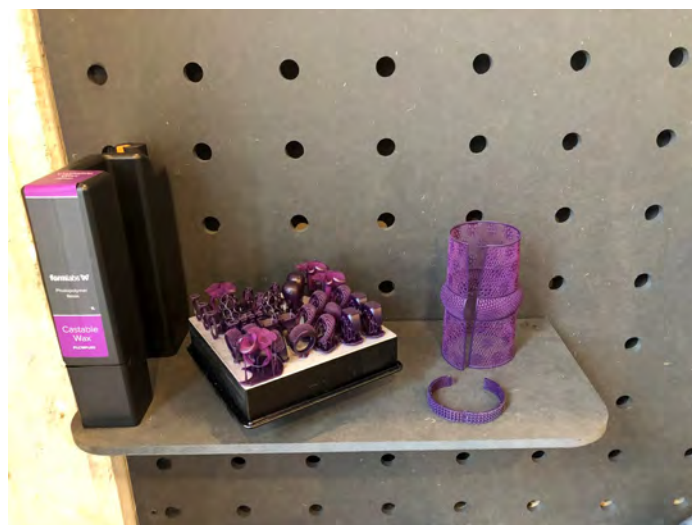
Slika 17 Primjer SLA tehnologije u proizvodnji nakita
