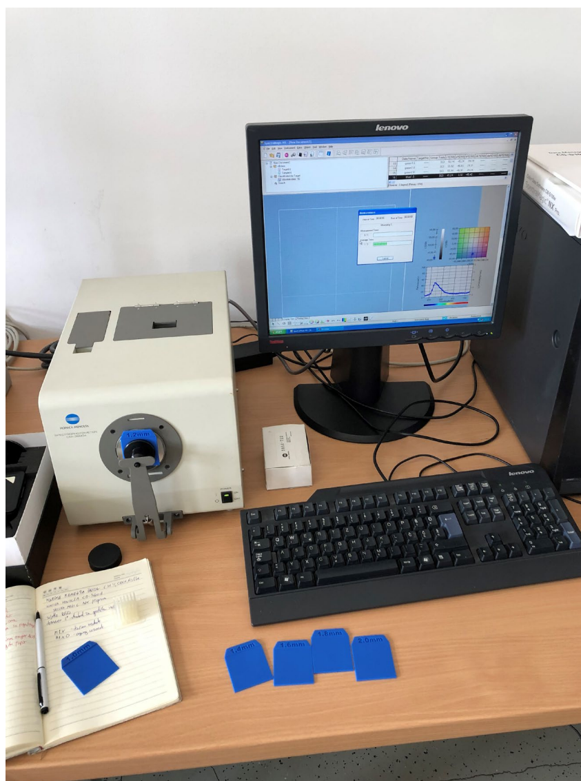
Slika 35 Spektrofotometar Konica Minolta CM3600dm
