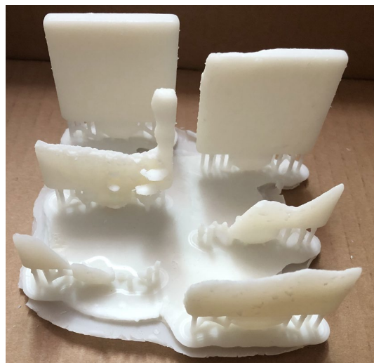
Slika 32 Ispitni uzorci degradiranih mehaničkih svojstava
