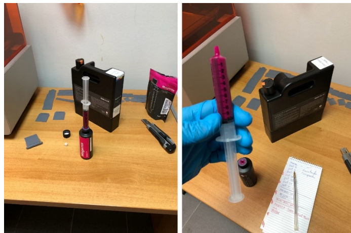
Slika 31 Doziranje bojila u spremnik
