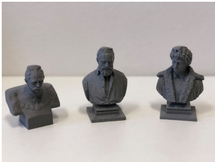
Slika 8 Replike kipova proizvedene FFF postupkom izrade
