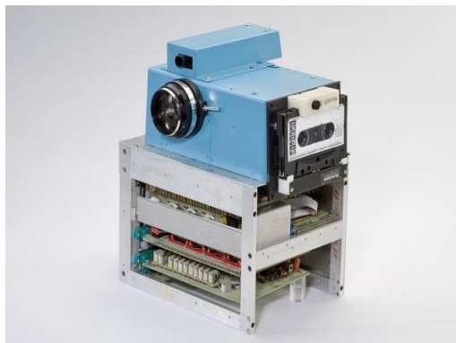
Slika 2. Prototip prvog digitalnog fotografskog aparata, 1975. godina.
