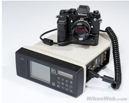
Slika 9. Kodak DCS-100 kamera sa svojom jedinicom za digitalno pohranjivanje (DSU).
