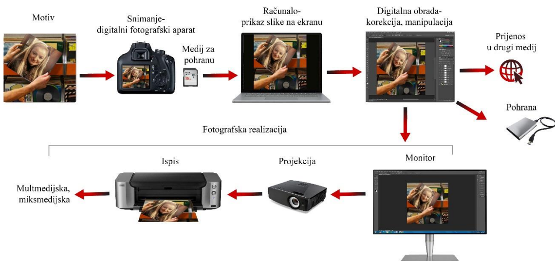
Slika 1. Shematski prikaz digitalnog fotografskog sustava
