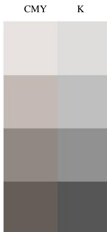
Slika 59. Kontrolni strip za određivanje optimalnog sivog balansa
