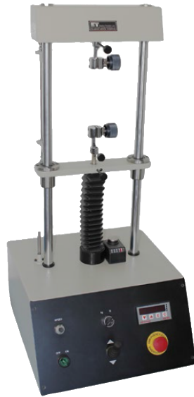
Slika P5.4. Enrico Toniolo Dynamometer Tensomini Super kidalica (poglavlje 3.2.1.5.)
