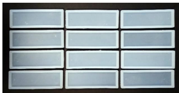
Slika 3.4. Silikonski kalupi za izradu epruveta adheziva
