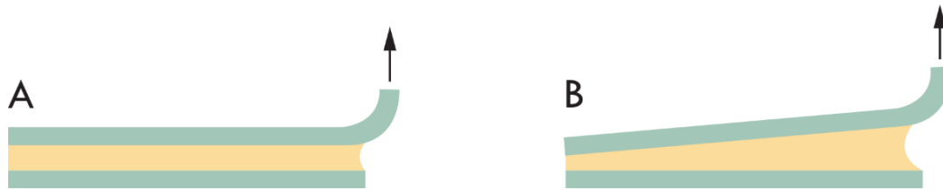
Slika 2.13. Kohezivne sile neelastičnog (A) i elastičnog (B) adheziva pri ljuštenju [75]
