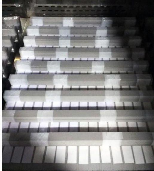
Slika 3.16. Izlaganje uzoraka za provedbu testa ljuštenja na definirane temperaturne uvjete i uvjete vlage u Kottermann klima komori
