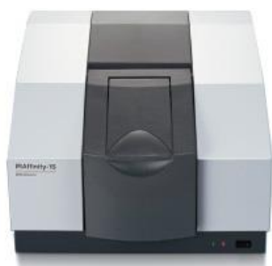
Slika P5.7. Shimadzu IRAffinity-21 FTIR spektrometar (poglavlje 3.2.4.)
