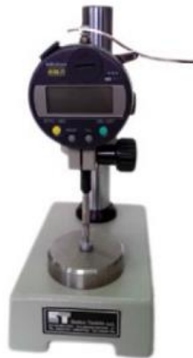
Slika P5.14. Enrico Toniolo DGTB001 mikrometar (poglavlje 3.3.1.3.)
