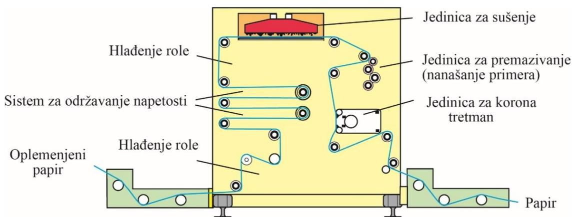
Slika 45. Prikaz jedinice za oplemenjivanje tiskovne podloge
