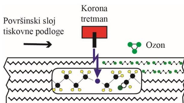
Slika 17. Shematski prikaz promjena u vršnom sloju tretiranog materijala – razbijanje kemijskih veza u polimernom lancu
