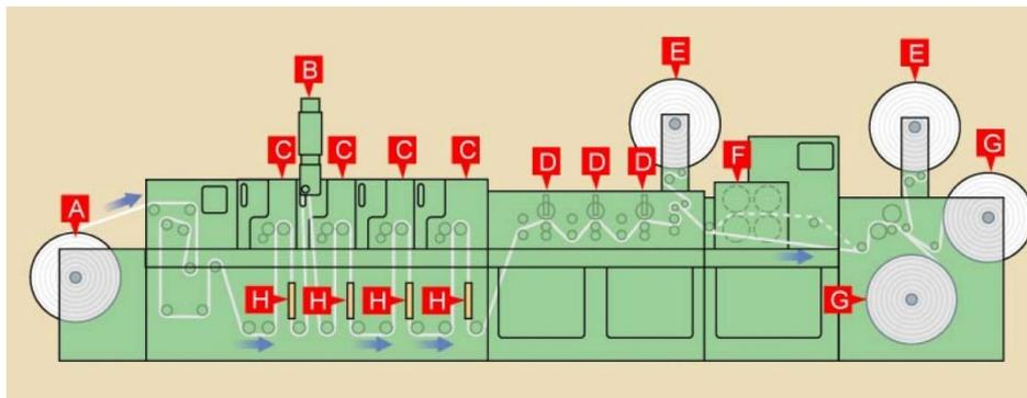
Slika 37. Fleksostroj za premazivanje s horizontalnom konstrukcijom
