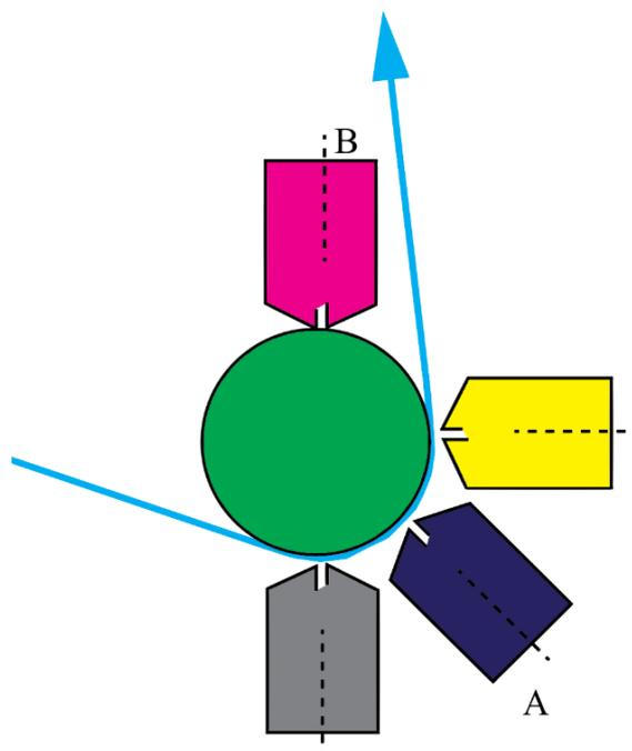
Slika 25. Satelitska konstrukcija jedinice za premazivanje
