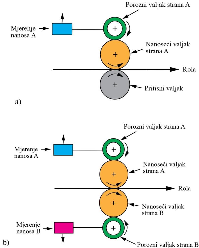
Slika 28. Shematski prikaz jedinice za premazivanje na principu pukotine: a) jednostrano premazivanje, b) obostrano premazivanje
