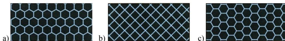
Slika 34. Struktura ćelija na anilox valjku: a) kut od 60°, b) kut od 45°, c) kut od 30°
