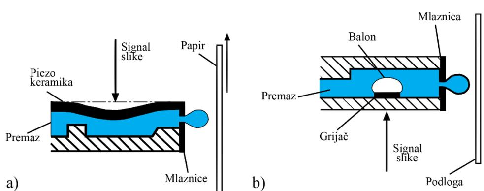
Slika 41. Prikaz principa Inkjet tiska na principu kapanja na zahtjev: a) piezo Inkjet, b) termalni Inkjet
