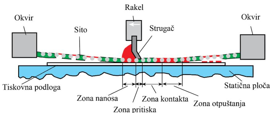
Slika 29. Shematski prikaz principa rada *flatbed* sitotiskarskog stroja
