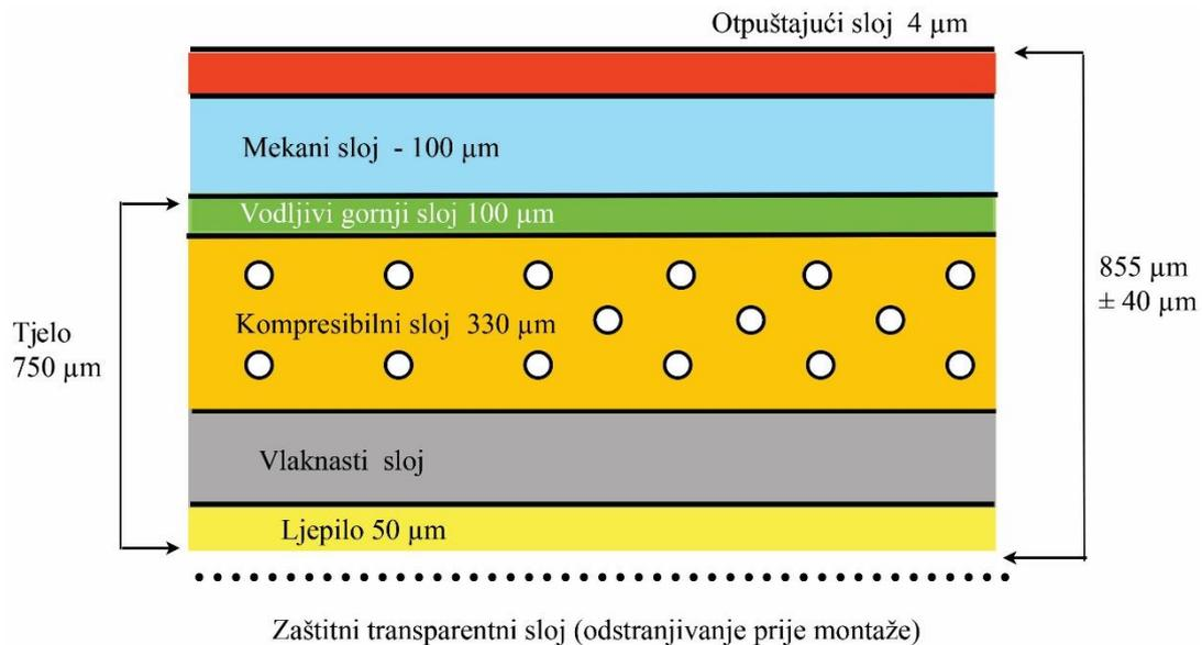
Slika 11. Struktura HP indigo ofsetne gumene navlake
