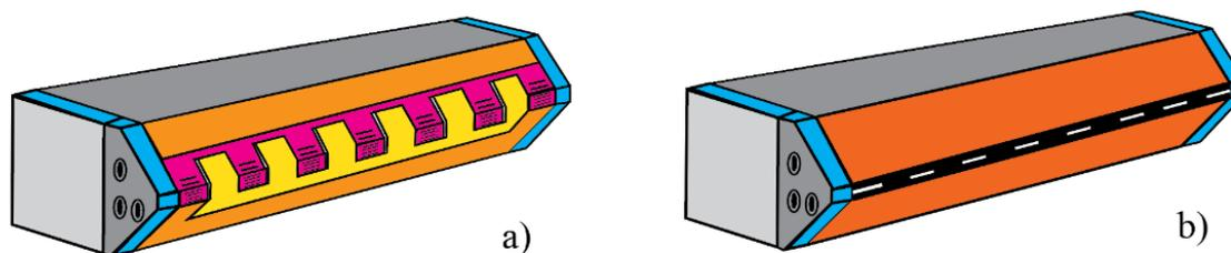
Slika 26. Shematski prikaz jedinice za parcijalno premazivanje: a) konstrukcija u obliku grablji, b) konstrukcija s polupropusnom vršnom pločom
