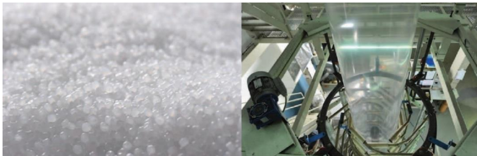
Slika 2.3. Granulat PE-LDa i ekstruder za proizvodnju PE-LD folije.
