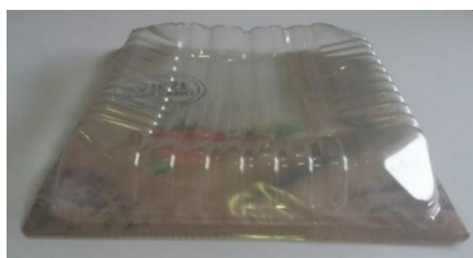
Slika 3.13. Termoformirana kadica (posuda za pakiranje) – donja folija.
