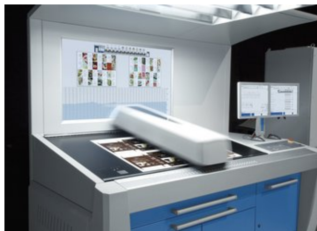
Slika 3.19. ErgoTronic ColorControl stroja KBA Rapida 105-5+L [89]
