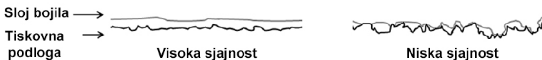
Slika 2.25. Ovisnost sjajnosti otiska o površinskoj strukturi tiskovne podloge: a) blago hrapava tiskovna podloga rezultira glatkim i sjajnim otiskom; b) hrapava tiskovna podloga rezultira otiskom male sjajnosti [40]
