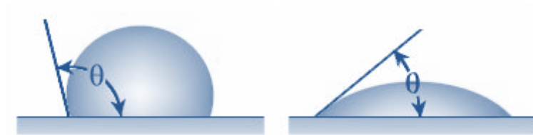
Slika 2.8. Prikaz mjerenja kontaktnog kuta
