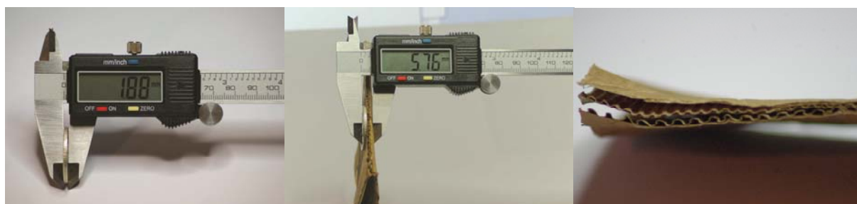
Slika 20. Mjerenje etalona i uzorka valovitog kartona
