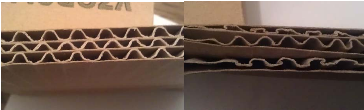
Slika 3. Uzorci valovitog kartona u vlažnom i suhom stanju
