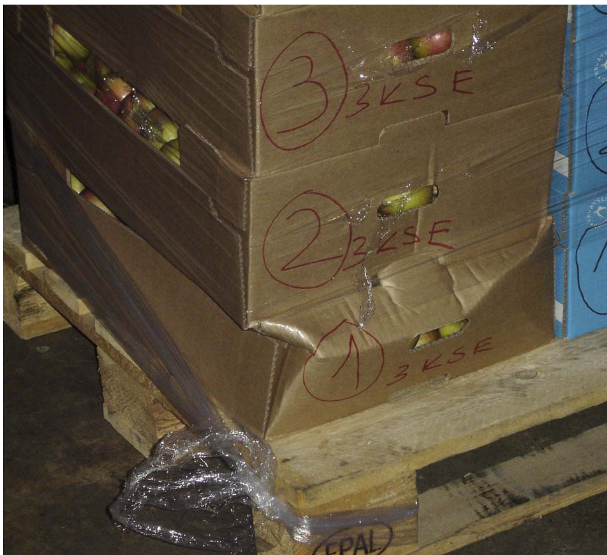
Slika 1. Deformiranje kutije pod opterećenjem vlastite težine i sadržaja
