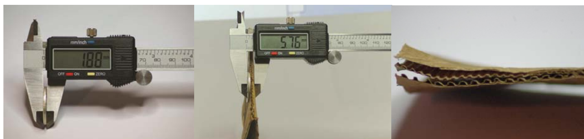
Slika 20. Mjerenje etalona i uzorka valovitog kartona
