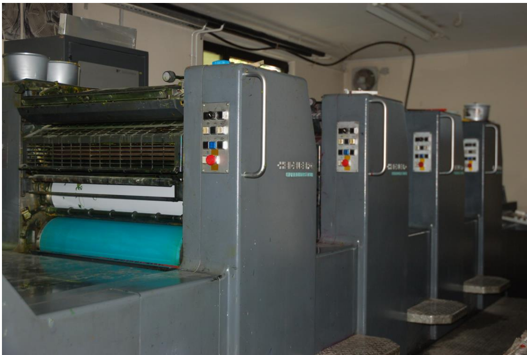
Slika 31 Četverbojni ofset tiskarski stroj Heidelberg za tisak iz arka u tiskari "Utrip" Brežice
