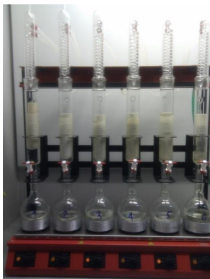
Slika 22. Ekstrakcija u Soxhlet-ov ekstraktoru (Zavod za tehnologije materijala, Sveučilište u Zagrebu, Šumarski fakultet)
