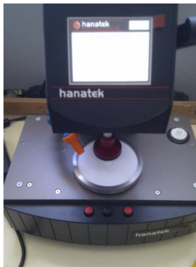
Slika 34. Tribometar za određivanje otpornosti otisaka prema otiranju (Katedra za materijale u grafičkoj tehnologiji, Sveučilište u Zagrebu, Grafički fakultet)
