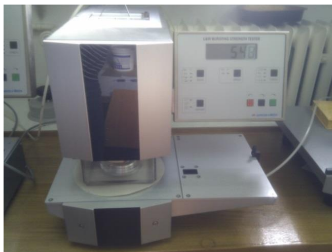
Slika 31. Uređaj za određivanje otpornosti prema prskanju (Katedra za ambalažu, knjigoveštvo i projektiranje, Sveučilište u Zagrebu, Grafički fakultet)
