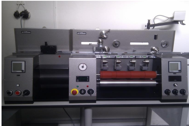
Slika 28. Uređaj za probno otiskivanje (Katedra za tiskovne forme, Sveučilište u Zagrebu, Grafički fakultet)
