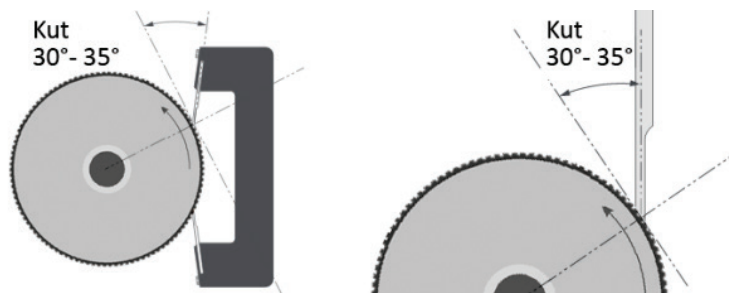
Slika 2.46 Kut oštrenja odstranjivača bojila prema aniloks valjku kod dva različita sustava za obojenje
