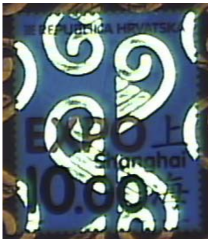
Slika 27. 2010. Franković& Vučić - Ultraljubičasti premaz papira na modernim hrvatskim markama
