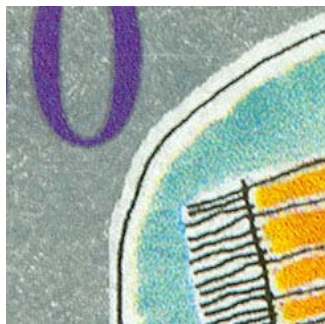
Slika 15. 1995. Lovrenčić - FM raster u kombinaciji sa posebnim bojama (motiv je uz procesne boje otisnut i srebrnom bojom)
