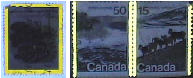
Slika 23. Zaštitni UV premaz na papiru izvan otisnute grafike motiva
