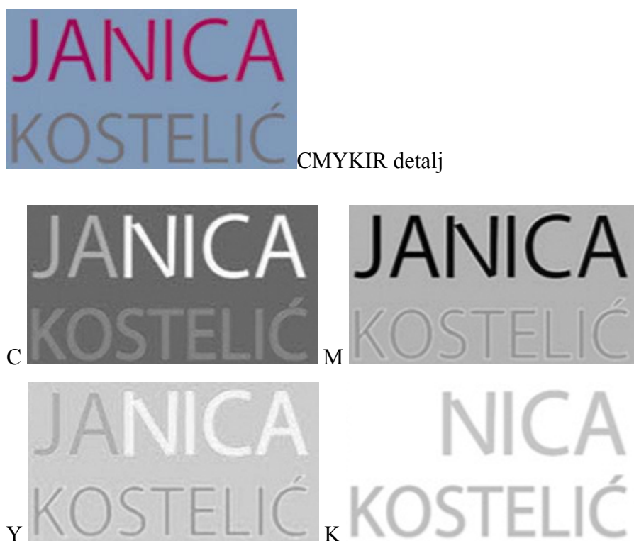
Slika 47. Detalj marke u vizualnom dijelu sa CMYKIR separiranim kanalima
