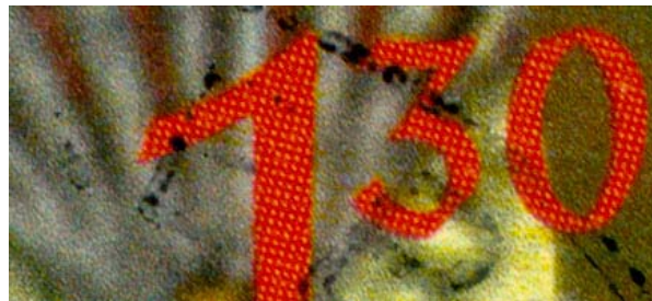
Slika 14. 1996. Artuković - FM raster u kombinaciji sa AM rasterom (tekst otisnut AM rasterom, a grafika u FM)
