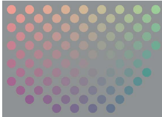
Slika 2.34. OSA sustav boja. Ravnina je konstruirana pod uvjetom da je L = j . Sve vrijednosti koordinata su sastavni dio ravnine. L vrijednost ide od -5 do 6 (dolje prema gore), a g vrijednosti idu od -10 do 6 (s lijeva na desno)
