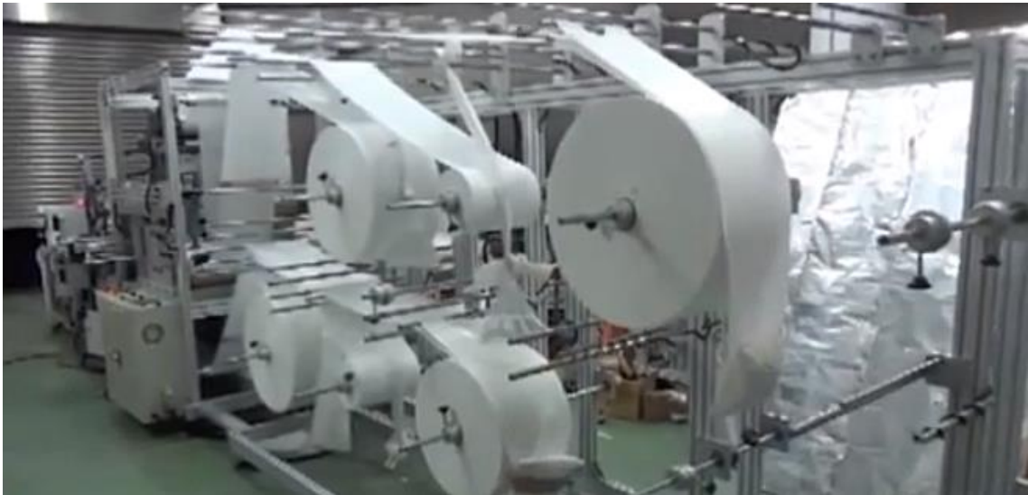
13. Role papira namontirane na uređaj KSONIC
