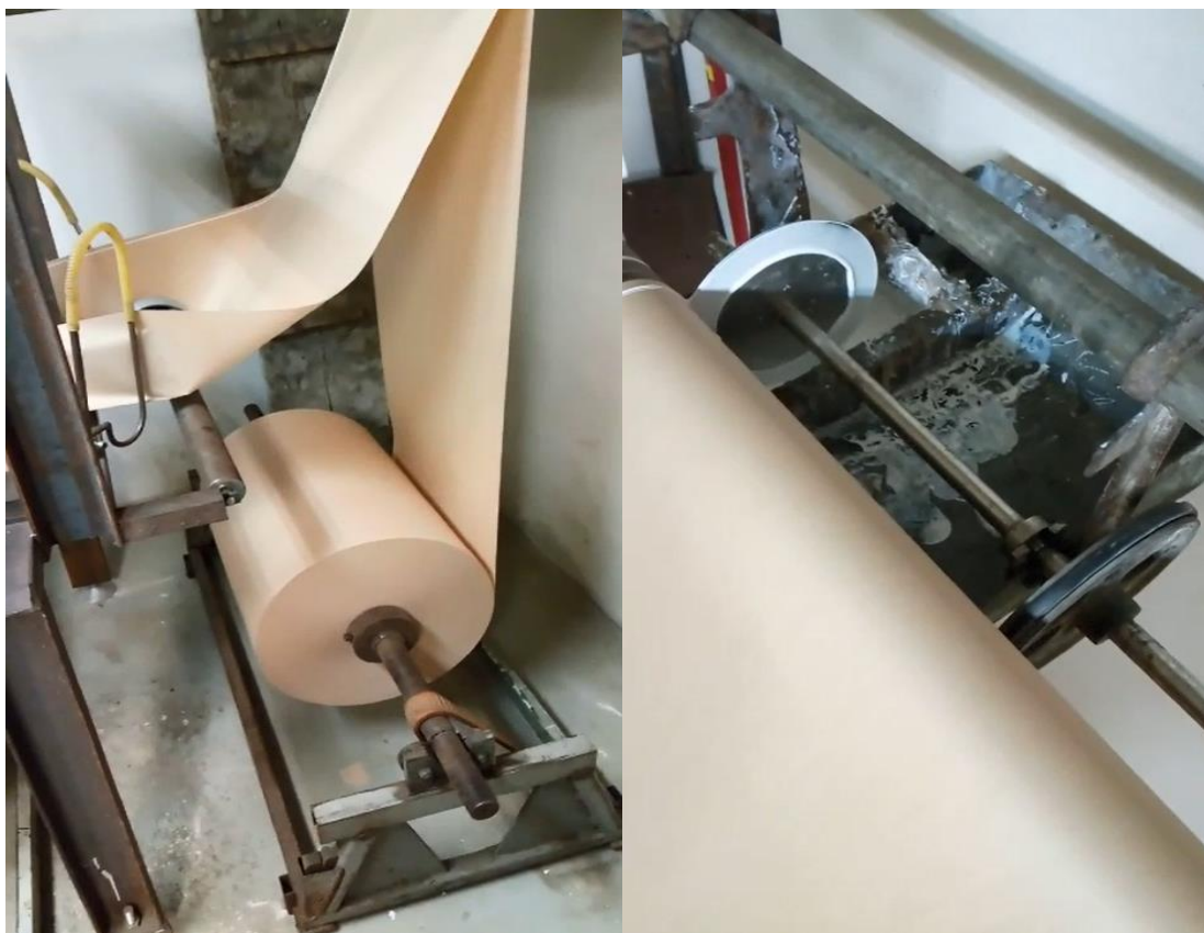
6. Namontirana rola papira i korito s lijepilom u uređaju za proizvodnju vrećica
