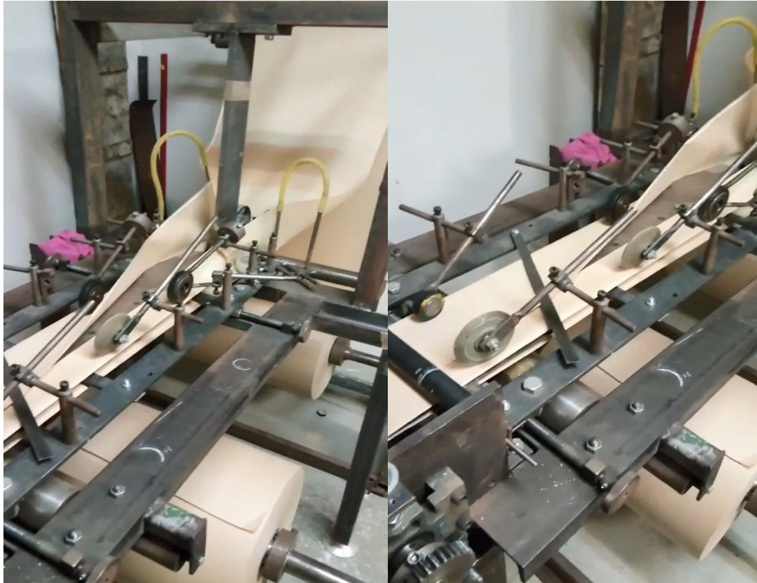
7. Savijanje role papira, njeno poravnavanje i lijepljenje lijeve strane s desnom
