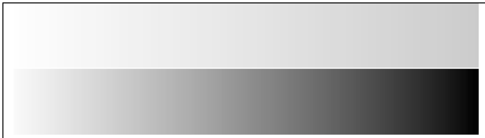
Slika 63. Kontrolni strip za određivanje linearnosti gradacije rastertonskih vrijednosti
