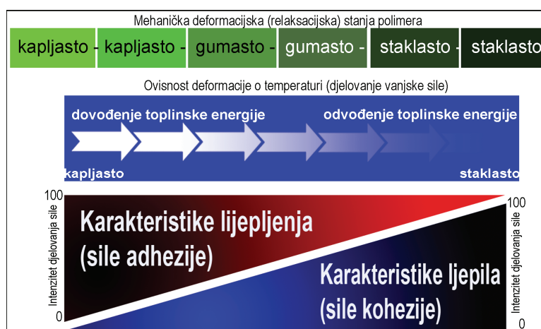
Slika 18. Utjecaj mehaničkih stanja termoplasta na promjenu čvrstoće spoja
