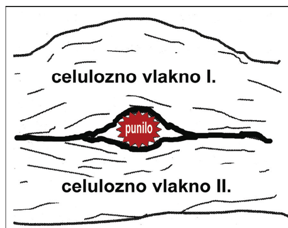
Slika 13. Čestica punila smještena između vlakana[25]
