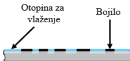
Slika 1. Tiskovna forma za plošni tisak nakon nanošenja otopine za vlaženje i bojila
