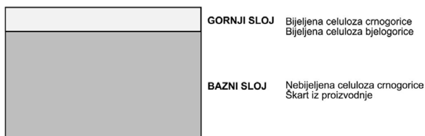
Slika 15. Shematski prikaz bijelog testlinera
