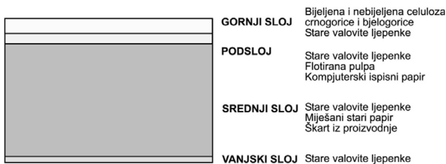
Slika 16. Shematski prikaz četveroslojnog testlinera
