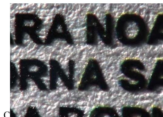
Slika 106 Kontrolirani nanos boje, uvećanje 95 puta. Koso obostrano skaniranje (A), desno koso skaniranje (B) i lijevo koso skaniranje (C).
