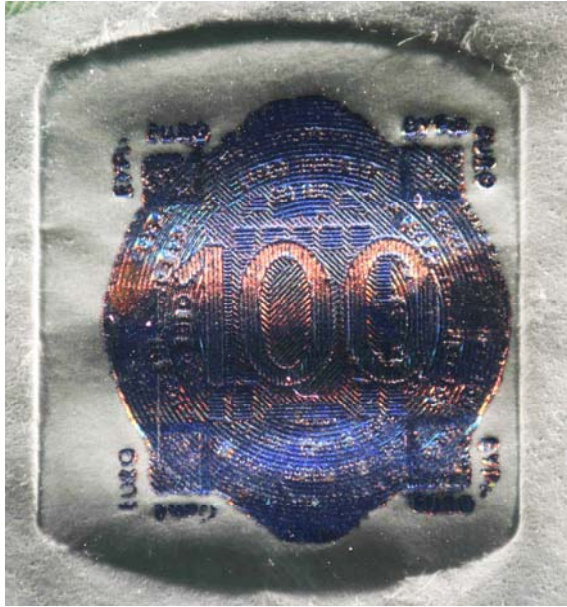
Slika 56. Reprodukcija holograma na krivotvorenoj novčanici od 100 eura indikativa P7, uvećanje 13 puta, koso obostrano svjetlo.
