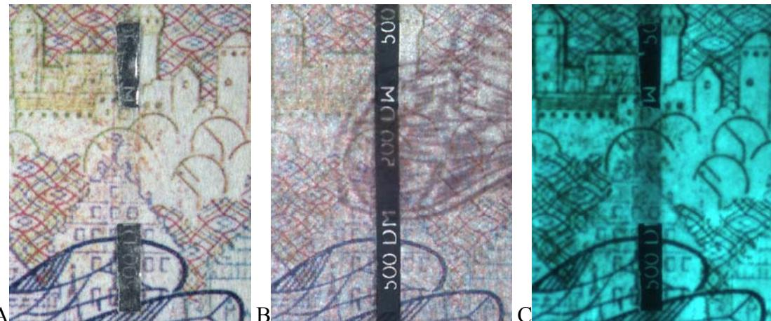
Slika 41. Reprodukcija zaštitne niti na krivotvorenoj novčanici od 500 DEM, uvećanje 7.4 puta. Imitacija bijelog svjetla (A), propusno svjetlo (B) i ultraljubičasto svjetlo od 365 nm (C).
