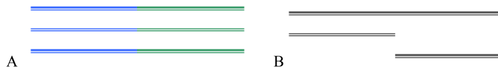
Slika 92 Kontinuirani prijelaz boje na vidljivom svjetlu (A) i pod IR svjetlom od 830 nm (B).
