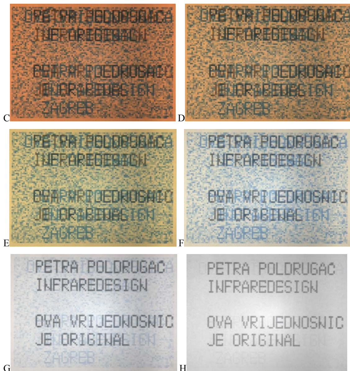
Slika 109 Put nestajanja i pojavljivanja informacija, uvećanje 3,4 puta. Imitacija bijelog svjetla (A), 570 nm (B), 645 nm (C), 665 nm (D), 695 nm (E), 735 nm (F), 780 nm (G) i 830 nm (H).
