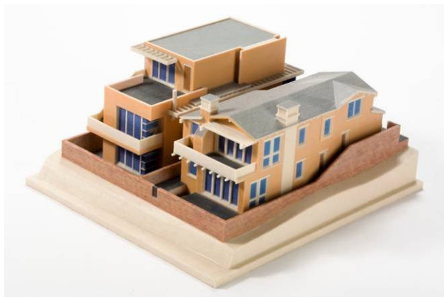
Slika 155. Primjer 3D otiska u boji, model kuće, ©ZCorporation
