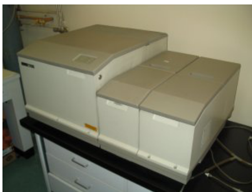
Slika 10. FT-IR spektrometar 1720-x tvrtke Perkin-Elmer
