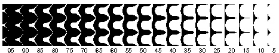
Slika 39. Izgled rasterskog elementa R93 sa kutem od 0° sa pokrivenošću od 95% do 5%
