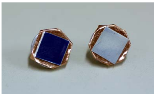
Slika 29. Nejetkan i jetkan (300 sekundi) TCXB-31 uzorak pripremljen za SEM
