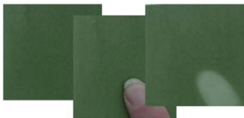
Slika 11. Fotografije otisnute termokromne boje koja reagira na temperaturu ljudskog tijela
