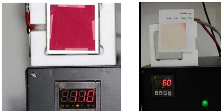
Slika 17. Grijač koji je korišten za mjerenja iznad 80^{\circ}\text{C} s elektronski zagrijavanom bakrenom pločicom
