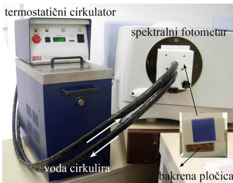
Slika 16. Termostatični cirkulator, način mjerenja s prednjim pogledom na bakrenu pločicu s uzorkom
