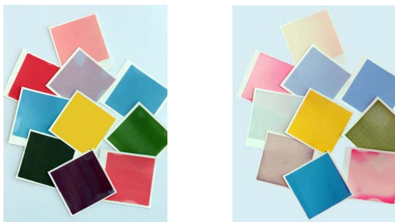
Slika 10. Fotografije otisnutih termokromnih uzoraka pri niskoj (lijevo) i visokoj (desno) temperaturi
