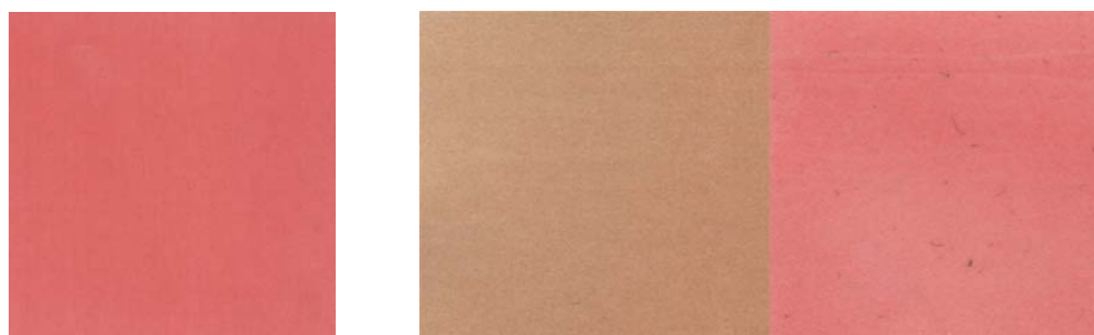
Slika 164. Fotografije TCXR-31 uzoraka bez procesa starenja te uzoraka s procesom starenja u trajanju od 24h, bez laka i sa ST lakom
