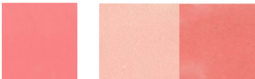
Slika 166. Fotografije SilitechRed-15 uzoraka bez procesa starenja te uzoraka s procesom starenja u trajanju od 24h, bez laka i sa ST lakom
