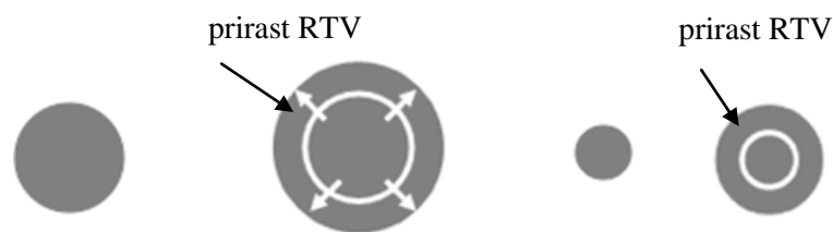
Slika 45. Ilustracija kompenzacije prirasta rastertonske vrijednosti a) željena veličina rasterskog elementa, b) otisnuti rasterski element s pripadajućim prirastom, c) smanjenje početnog rasterskog elementa, d) konačni otisnuti rasterski element
