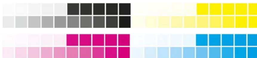
Slika 67: Kontrolni strip na kojemu se radilo mjerenje (dimenzije jednog polja su 5x5 mm)
