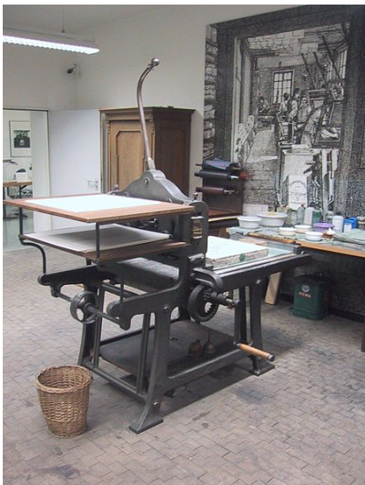
Slika 17: Litografski stroj na kojemu je otisnuta zemljopisna karta grada Moosburga
