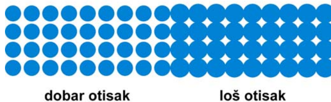
Slika 49: Utjecaj prirasta rasterskog elementa na kvalitetu reprodukcije
