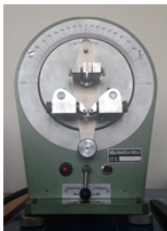
Slika 17. i 18. Taber uređaj proizvođača Frank
