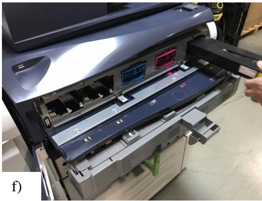
Slika 18. Postupak promjene seta tonera: a) početni CMYK set; b) CMY set nakon izvlačenja fotokonduktora; c) u fotokonduktoru nakon vađenja iz mašine; d) novi ubačen set sa fluorescentnim razvijajcima i fotokonduktorima; e) stroj u fazi sa izvučenim CMY tonerima; f) ubacivanje kućišta novog seta tonera
