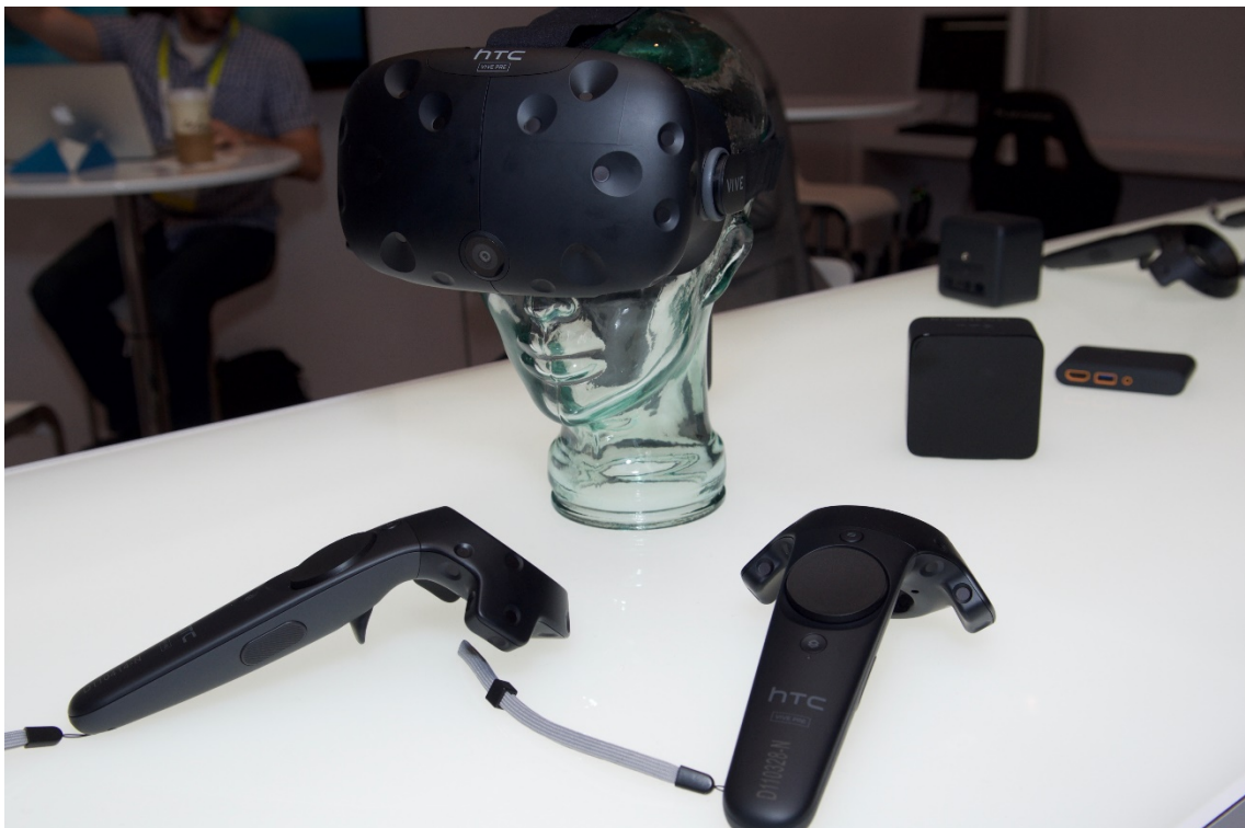
Slika 39 Prikaz HTC Vive uređaja s dva kontrolera i dvije bazne stanice u obliku kocke [11]
