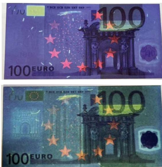
Slika 45. Razlike između izvorne novčanice od 100 eura (gore) i krivotvorene (dolje) u UV spektru
