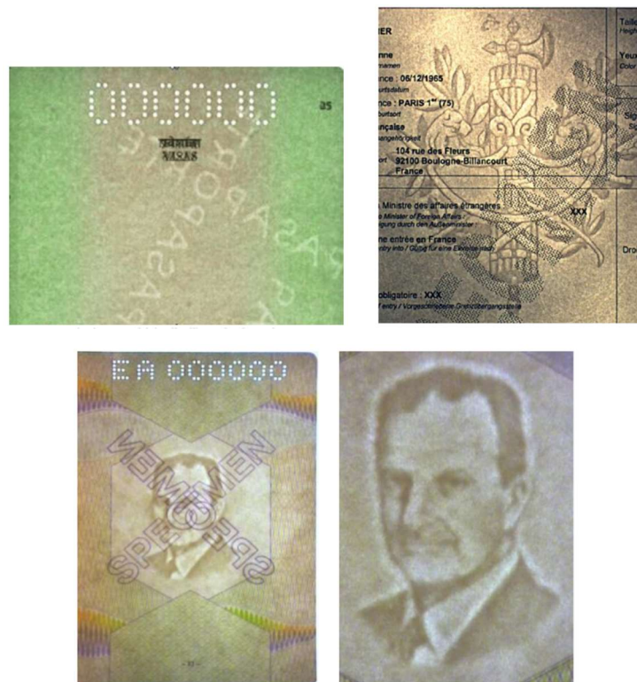
Slika 31. Jednotonski vodeni znak (gore lijevo), dvotonski vodeni znak (gore desno), višetonski vodeni znak (dolje)
