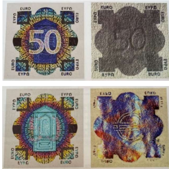
Slika 47. Izvorni (lijevo) i imitirani hologrami (desno)
