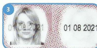
MLI ® Dvostruka laserska slika / Multiple laser image
