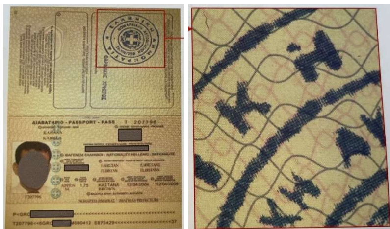
Slika 54. Otuđeni bianco obrazac putovnice koja nije ovjerena otiskom pečata nadležnog tijela, nego je on ispisan primjenom laserskog pisača u boji
