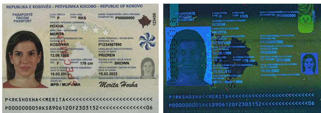
Slika 34. Lice putovnice u vidljivom (lijevo) i UV (desno) spektru
