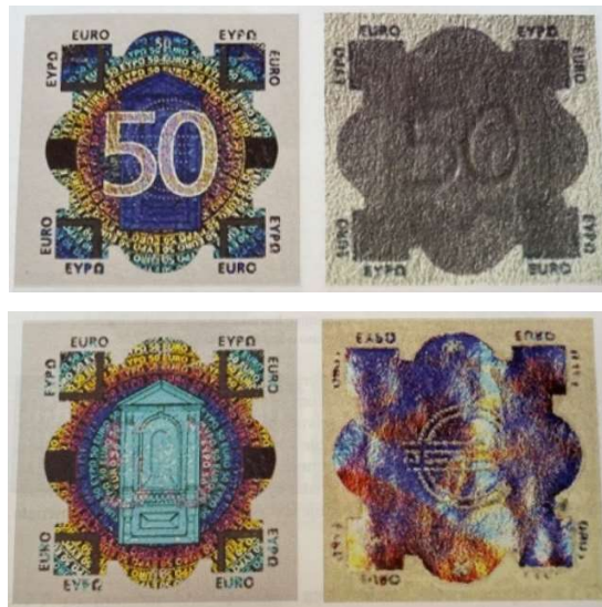
Slika 47. Izvorni (lijevo) i imitirani hologrami (desno)
