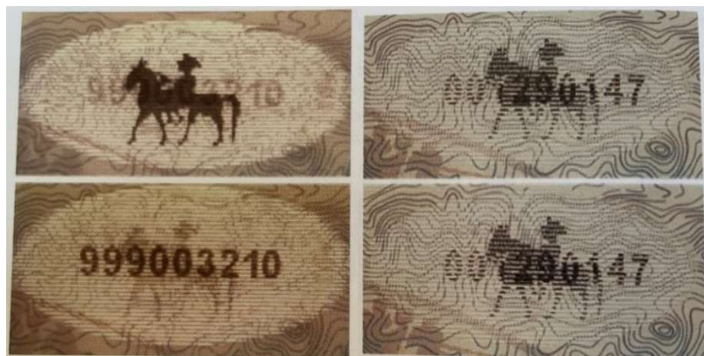
Slika 48. Razlike između promjenjive laserske slike izvornika (lijevo) i krivotvorene (desno) ovisno o kutu upada svjetlosti
