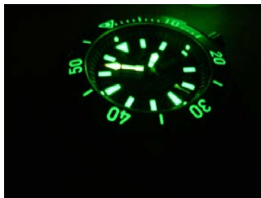
Slika 8 – Prikaz sata s detaljima premazanim radioluminiscentnim slojem [32]
