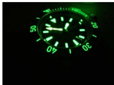
Slika 8 – Prikaz sata s detaljima premazanim radioluminiscentnim slojem<sup>[32]</sup>
