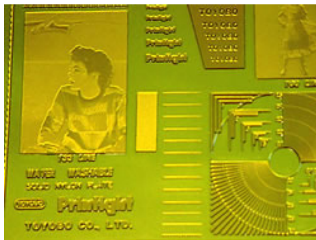
Slika 13 – prikaz polimerne tiskovne forme za fleksotisak [40]
