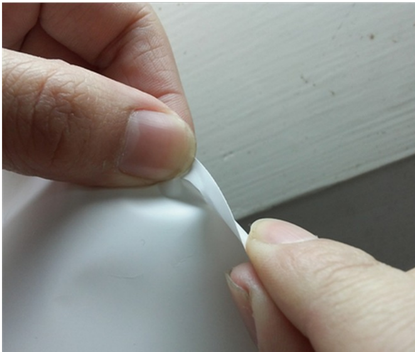
Slika 7 – otpornost sintetičkog papira na kidanje [23]
