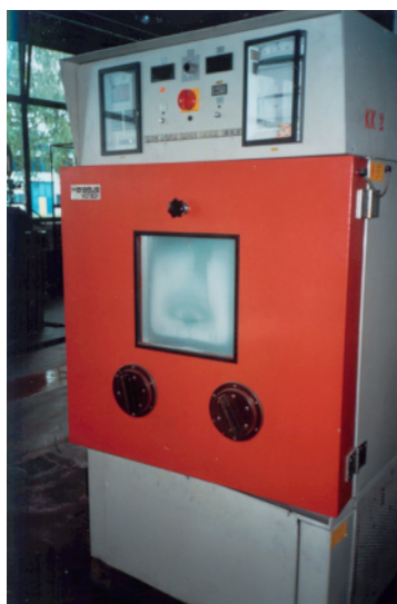
Slika 53. Hidrometerološka komora VUK 08/500
