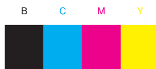
Slika 23. Segment FOGRA stripa koji služi za određivanje gustoće obojenja punog tona
