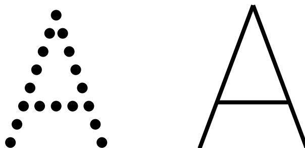
Slika 38 – Rastersko (lijevo) i vektorsko (desno) graviranje
