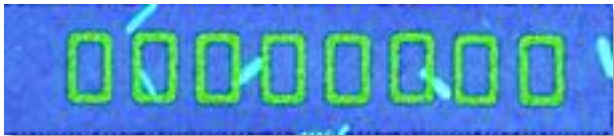
Slika 14 - Primjer UV luminiscirajuće knjigotiskarske boje pod UV izvorom svjetla otisnute mehaničkim numeratorom
