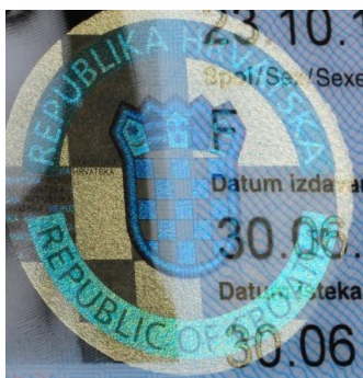
Slika 16 – Transparentni Kinegram® na identifikacijskoj stranici putne isprave RH (izvor: AKD)
