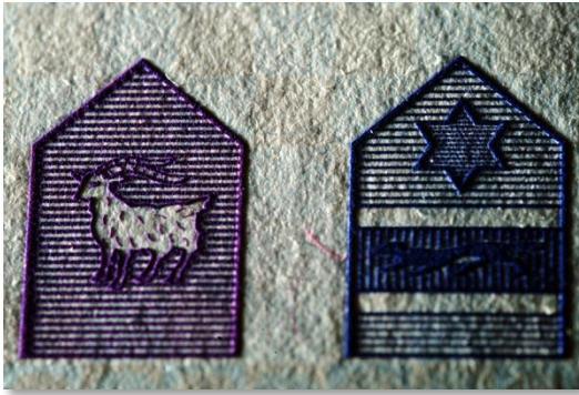
Slika 10 - Primjer dvobojnog intaglio tiska (izvor: AKD)
