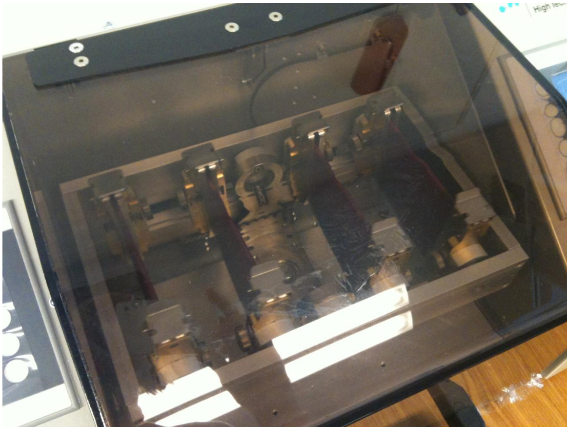
Slika 70 – Slika testiranja putovnica metodom torzijskog zamora (izvor: AKD)
