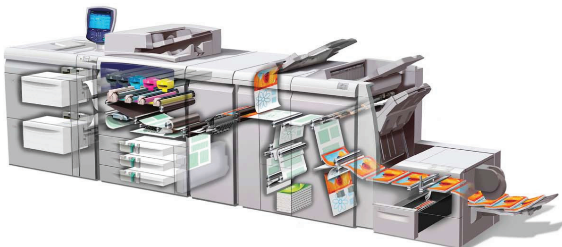
Slika 37 Shema prolaza tiskovnog arka kroz stroj
