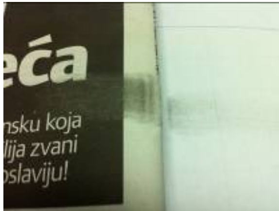
Slika 47. Primjer ispitivanja otiranja boje, odnosno upojnosti. Karakterizirati kao loše sušenje u primarnoj penetraciji
