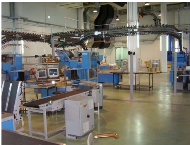
Slika 11. Novinska otprema s transportnim trakama
