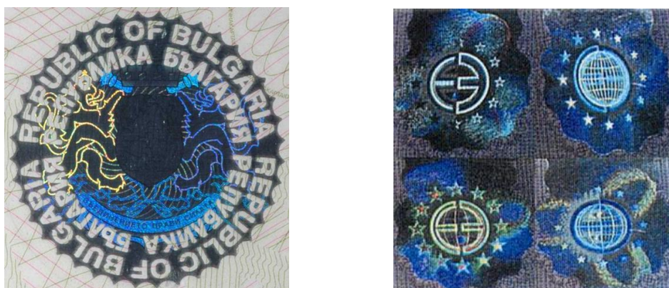
Slika 24: Parcijalno demetaliziran i potpuno metaliziran Kinegram®
