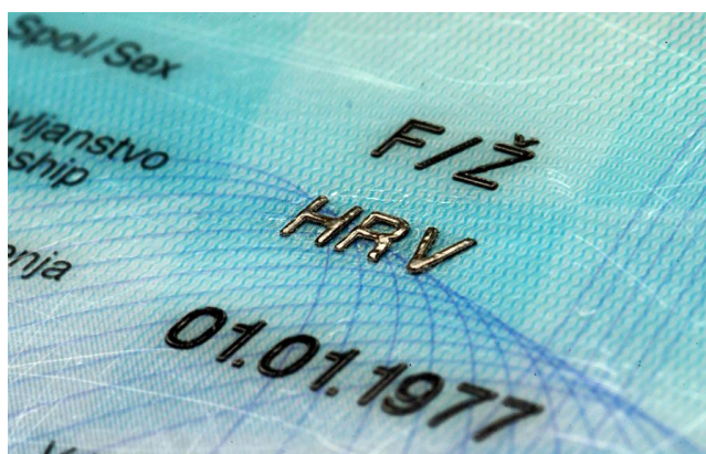
Slika 27: Rezultat dubinskog i reljefnog laserskog graviranja
