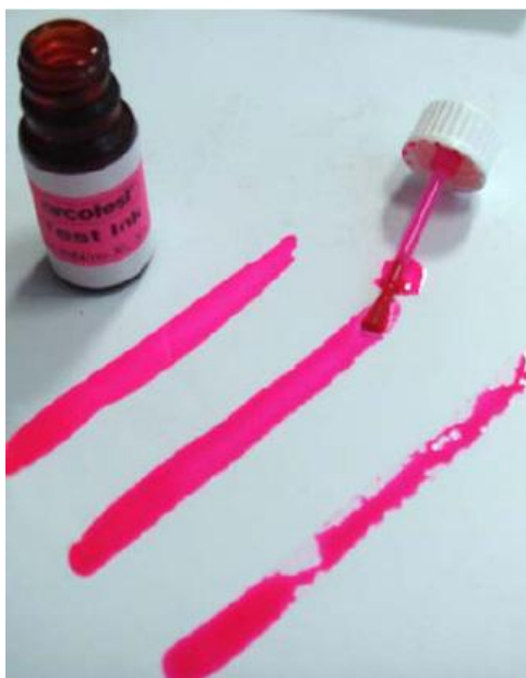
Slika 39: Vidljivi rezultat testiranja površinske napetosti sintetske tiskovne podloge
