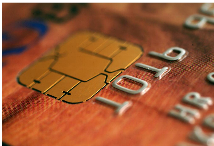
Slika 2: Reljefno ispupčeni znakovi sa srebrnom „tipping“ folijom
