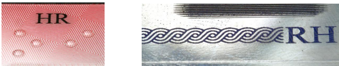
Slika 25: Braille-ovo pismo, motiv pletera i lentikularni žljebovi
