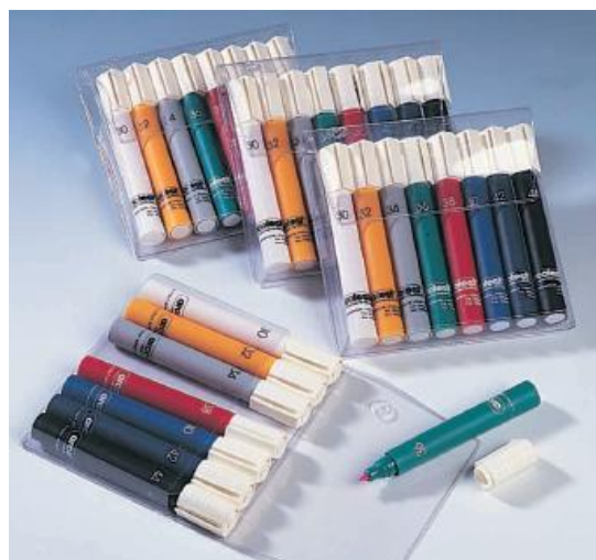
Slika 38: Oprema za testiranje površinske napetosti sa specificiranim vrijednostima u Mn/m
