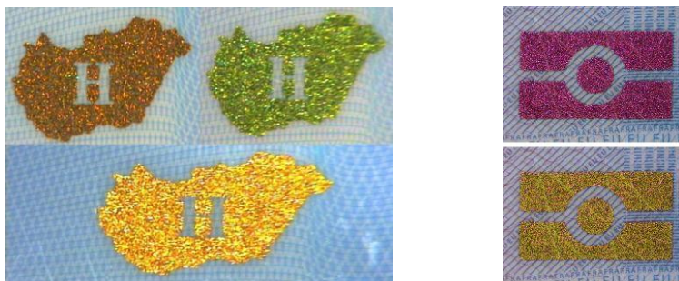
Slika 15: Izmjena OVI boja - zlatno-zeleno-bakreno i magenta-zlatno [19]
